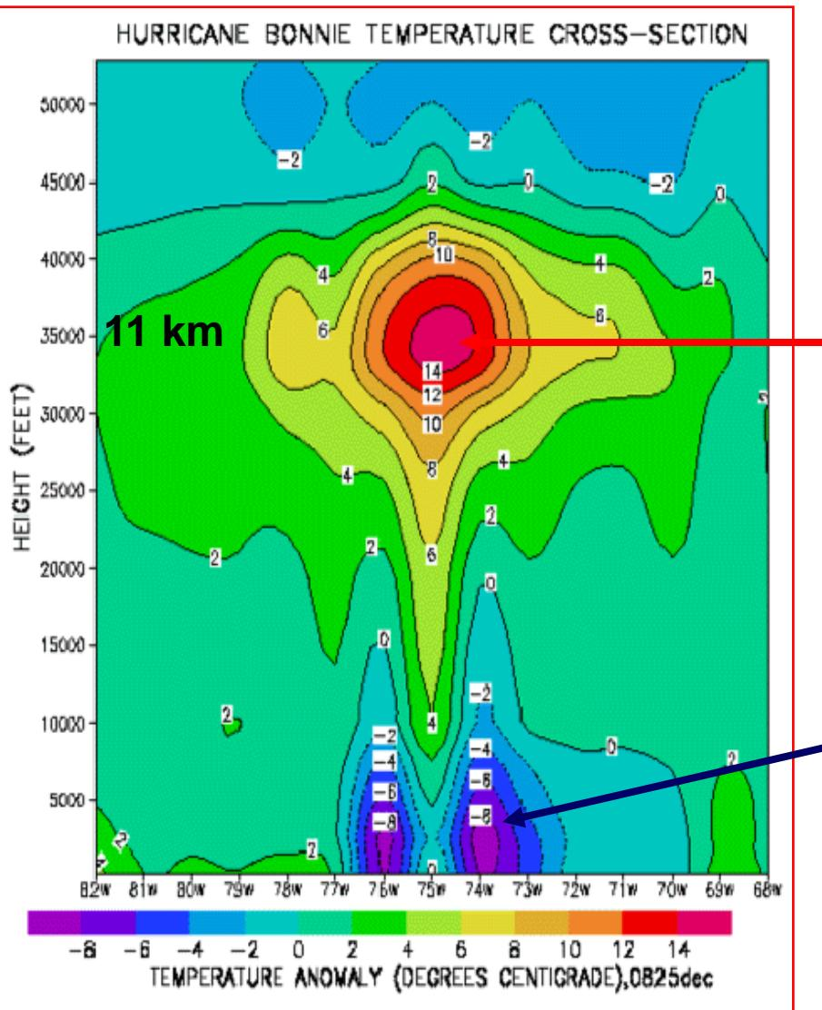
Coupe transversale de l'anomalie de température dans le cyclone BONNIE, calculée d'après AMSU-A.
